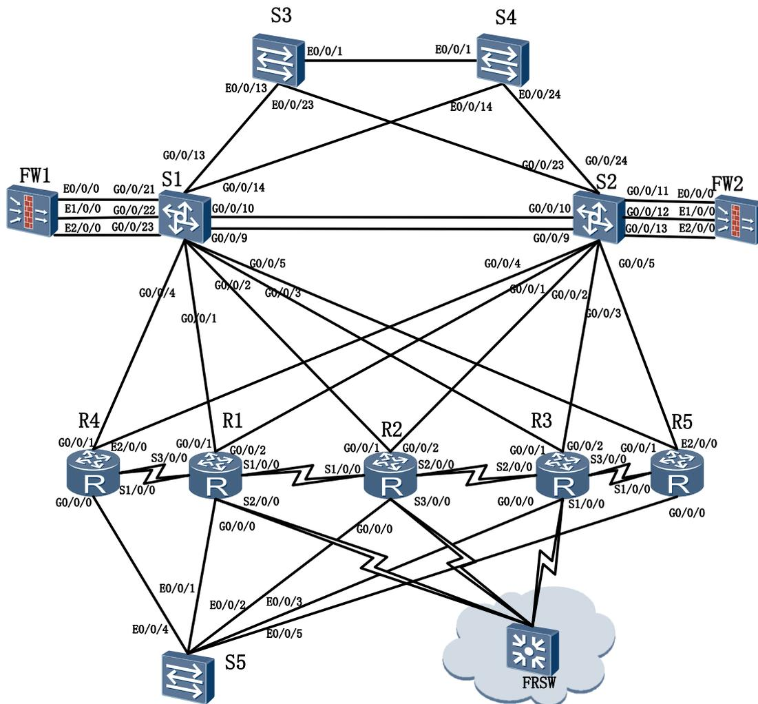
线缆连接时需要注意，连接FRSW与R1、R2、R3的串口线，注意将串口线缆的DCE端连接到FRSW。
